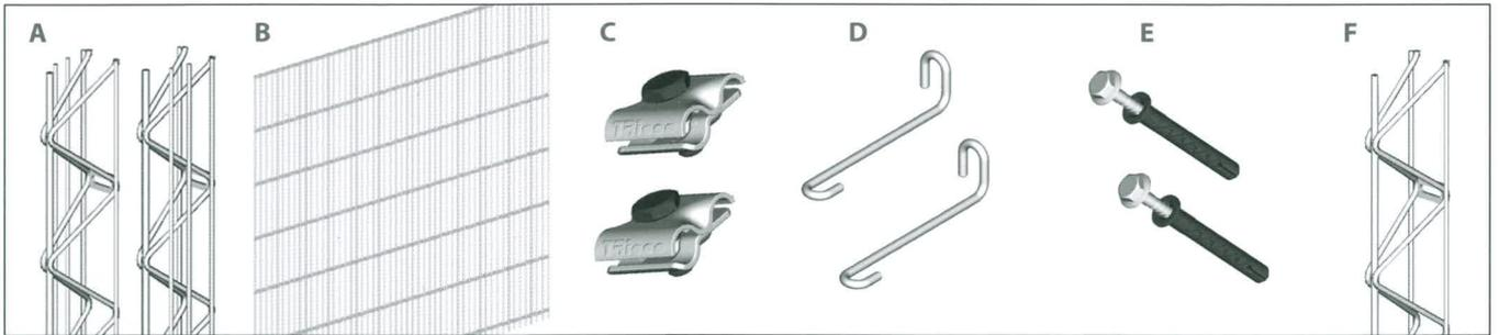
Sicht-Fassadenträger senkrecht an die Wand halten, Bohrstellen anzeichnen und Löcher für Dübel gem. statischer Berechnung 026/09 des Herstellers bohren. Sicht-Fassadenträger mittels Fassadendübel und Schraube befestigen und auf Zugfestigkeit überprüfen.
