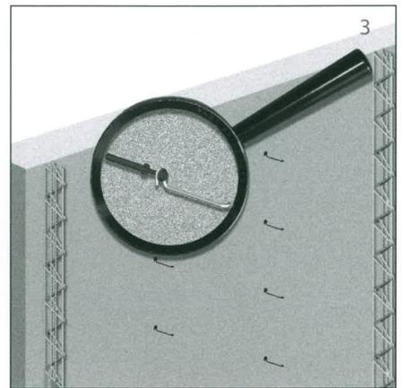
Gittermatte in die Abstandhalter einhängen und anschließend mit Universalklemmen Standard an den Fassadenträgern (13er Steckschlüssel) gem. Grafik 8 befestigen.
